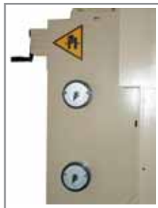
Indicatori della snervatura e della raddrizzatura Numerical gauge to adjust yield- ing and straightening rolls
