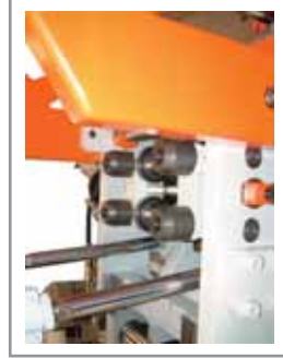
Guidanastro con indicatore numerico Entry guides with numerical gauge
