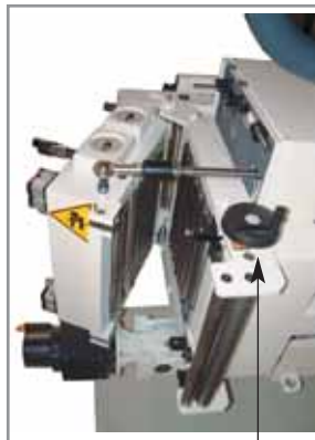
Apertura pneumatica della testa per la pulizia dei rulli e per lo sgancio piloti ad ogni colpo della pressa. Pneumatic head's opening for rolls cleaning and complete opening of the upper part so that the strip can be released at each press stroke
