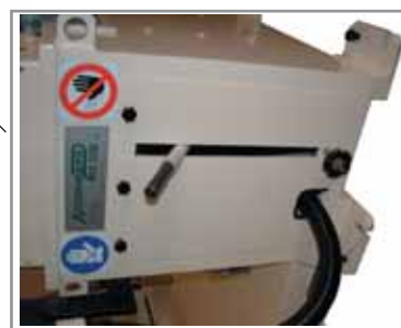
Sollevamento idraulico per ade- guarsi alle diverse altezze degli stampi Hydraulic height adjustment for the different moulds heights
